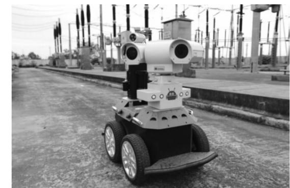
全力解决机器人上台阶的问题。该团队开发的“小卒一号”安防机器人头上装着4个摄像头，能在小区里自由行走，无需人工控制，提供全方位无死角监控保障，只需充电4小时，可以不间断巡逻8小时。
